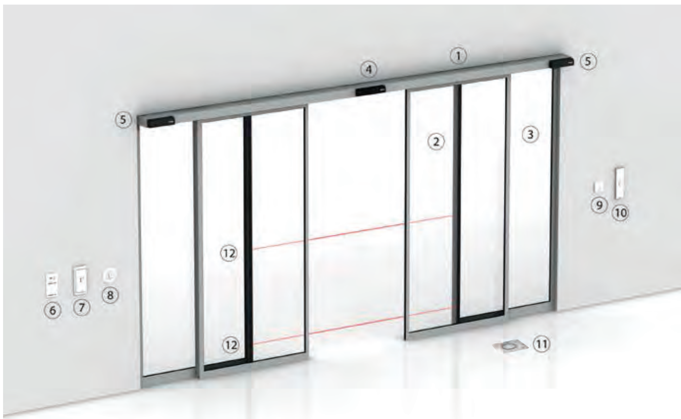
1 = Accionamiento de la puerta corredera | 2 = Hoja móvil | 3 = Panel lateral | 4 = Detector combinado | 5 = Detector de infrarrojos activo | 6 = Interruptor de programa con llave | 7 = Interruptor de codo | 8 = Interruptor de cristal con sensor LED | 9 = Interruptor de proximidad sin contacto | 10 = Interruptor de codo | 11 = Interruptor de pie con sensor LED | 12 = Fotoeléctrico.
